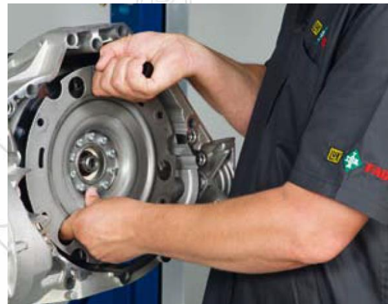
Attrezzo da inserire sull'asse delle ruote motrici per sorreggere assialmente l'unità frizione.
