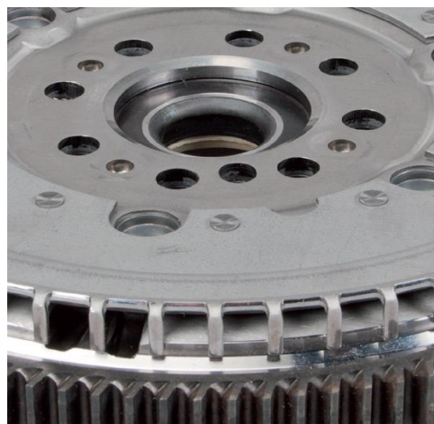
Figura 2: nuova versione dell'anello del sensore giri
