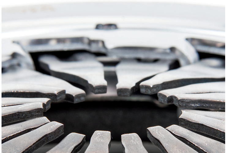
Figura 1: disallineamento delle estremità della molla a diaframma con frizione smontata
